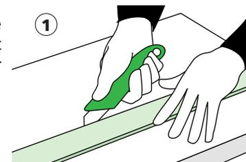
2 Mettre la plaque debout afin de la plier au niveau de la coupe. Repasser un coup de cutter sur le côté opposé pour terminer la coupe.
