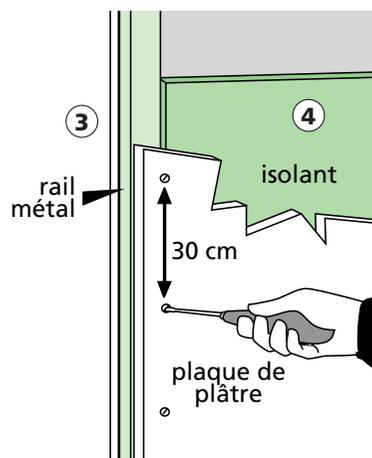
4 Placer l'isolant entre les montants. Sur la seconde face, procéder de façon identique pour positionner les plaques. S'assurer cependant que le même montant ne supporte pas les joints entre les plaques de part et d'autre de la cloison (alterner).
