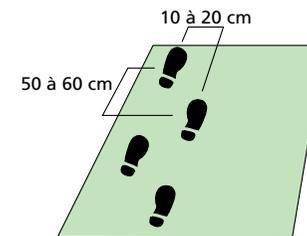
**2** Creuser des trous légèrement plus profond que l'épaisseur des pierres, puis déposez un peu de terre meuble dans le fond.
