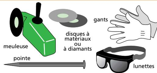
Les coupes de dalles sont tracées avec une pointe et réalisées avec une meuleuse équipée d'un disque à matériaux ou diamants. Par sécurité, le port des gants et des lunettes est recommandé pendant la découpe.
