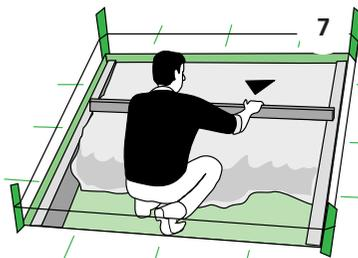
7 Faire coulisser une grande règle métallique en suivant la pente créée par les chevrons parallèles pour lisser le sable en une couche bien rectiligne.
