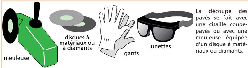
La découpe des pavés se fait avec une cisaille coupe-pavés ou avec une meuleuse équipée d'un disque à matériaux ou diamants.
