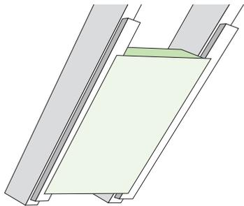
1 Disposer des bandes d'isolant (pare-vapeur vers vous) entre les chevrons, en commençant par le haut et en partant d'un angle.
