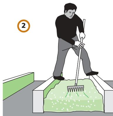
2 En prenant appui sur les solives, égaliser la vermiculite ou la laine minérale, soit à l'aide d'une planchette de bois adaptée à l'épaisseur de vermiculite souhaitée, soit à l'aide d'un râteau.
