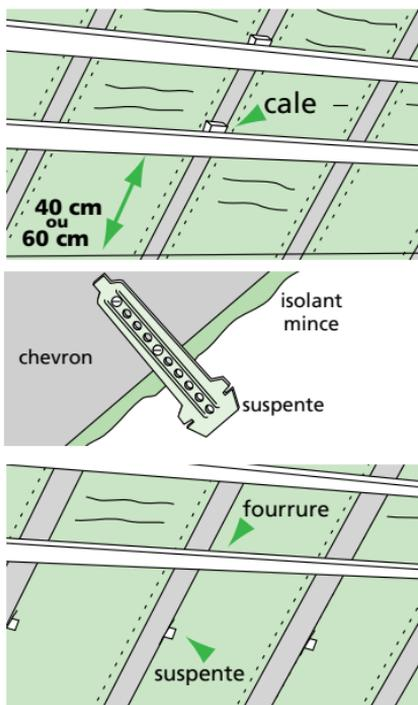
Clipser les fourrures sur les suspentes, puis visser les plaques de plâtre.
