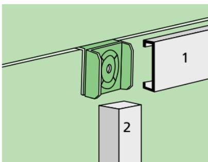
Les clips pour fourrure métallique ou liteaux se fixent par rotation
