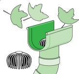
Ne pas coller la descente à la naissance pour pouvoir démonter facilement celleci en cas d'obturation (par des feuilles ou un nid par exemple). Si la toiture est située à proximité d'arbres, disposer éventuellement une crapaudine ou un arrêt de feuilles afin de prévenir l'obstruction du tuyau par les feuilles d'arbres.
