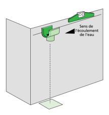
6 Fixer les crochets intermédiaires en suivant la pente et en les espacant de 40 cm maximum.
