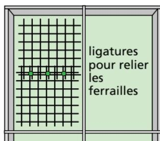
**Attention !** Respecter 2 cm d'espace entre le bord de la dalle et le treillis soudés afin d'éviter les remontées d'humidité par la ferraille et l'oxydation extérieure du béton.
