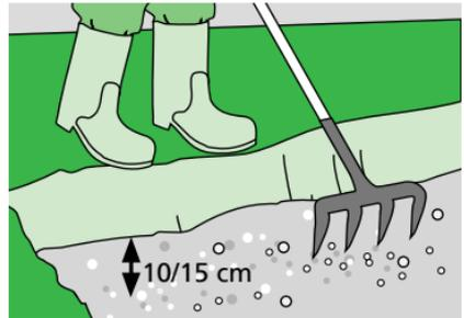
Disposer des pierres dans le fond de la tranchée sur une hauteur d'environ 10 à 15 cm en les répartissant sur toute la surface avec le râteau.
