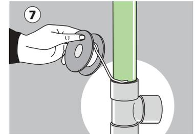
Pour le brasage fort : approcher la baguette et appliquer-la à la jointure. Il faut continuer de chauffer les pièces mais ne pas exposer la baguette à la flamme.
