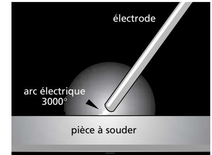
L'électrode est un fil métallique enrobé. Une extrémité de l'électrode est dénudée sur 15 mm environ, ce qui permet d'établir le contact électrique.
