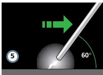
5 Souder en tirant l'électrode vers soi, inclinée à 60°. Garder une vitesse régulière en maintenant un écart constant de 2 à 3 mm. Descendre la main au fur et à mesure de l'usure de l'électrode pour compenser la fusion de l'électrode.
