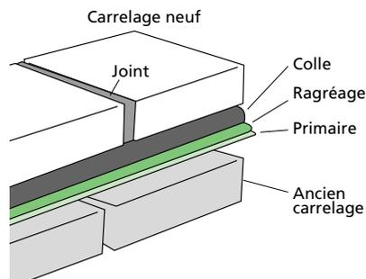
Nettoyer le carrelage à l'aspirateur et lessiver avec une lessive alcaline (type St Marc). Piquer l'ancien carrelage s'il est très lisse. Appliquer un primaire si nécessaire. Effectuer un ragréage en cas d'irrégularités dans le sol.
