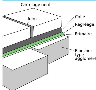
Nettoyer le plancher à l'aspirateur et lessiver avec une lessive alcaline (type St Marc). Appliquer un primaire si nécessaire. Effectuer un ragréage en cas d'irrégularités dans le sol.
