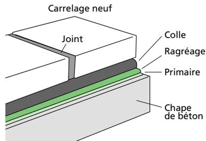
Nettoyer la chape à l'aspirateur et lessiver avec une lessive alcaline (type St Marc). Appliquer un primaire si nécessaire. Effectuer un ragréage en cas d'irrégularités dans le sol.
