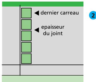
En mesurant, procéder à une simulation de pose pour optimiser les coupes et choisir la solution la plus esthétique.
