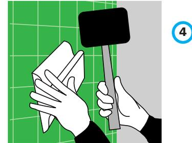
La batte doit reposer à cheval sur plusieurs carreaux.
