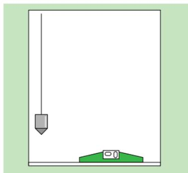
Contrôlez le niveau et l'aplomb des maçonneries ou tableaux. En cas de mauvais équerage, le réglage se fait avec des cales de rattrapage.
