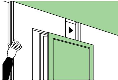
Une fois la cloison montée, ouvrir la porte et visser, par l'intérieur le bâti dans l'épaisseur de la cloison.
