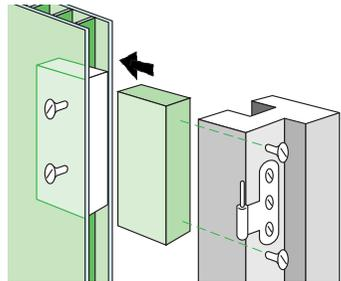
Pour les cloisons en plaque de plâtre, poser à la hauteur des paumelles des taquets de bois pour y visser le bâti.
