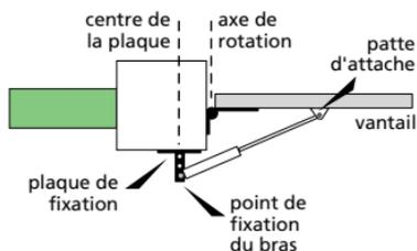
a) si le vantail est inférieur ou égal à 1,50 m de large (portail standard de 3 m)
