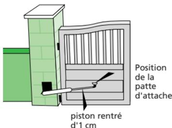
Rentrer le piston d'1 cm dans le vérin. Ceci détermine la position de la patte d'attache sur le vantail.
