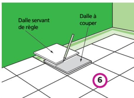
Poser la dalle A et placer la coupe contre le mur, le côté recoupé contre la plinthe.
