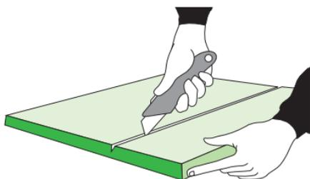
Poser la coupe le long du mur (le côté recoupé doit se trouver contre la plinthe)
