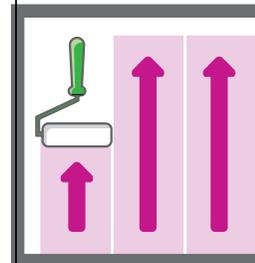
**3 Réalisez le décor** en passant un rouleau crépi "grain fin" ou "trous brûlés" ou un rouleau en caoutchouc lentement et régulièrement du bas vers le haut.
