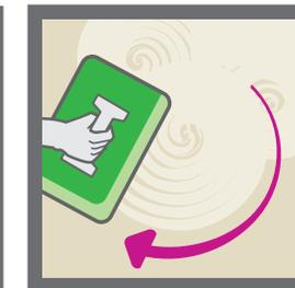
**2** Pour une finition talochée, **passez la taloche par mouvements circulaires** en veillant à avoir une surface uniforme.
